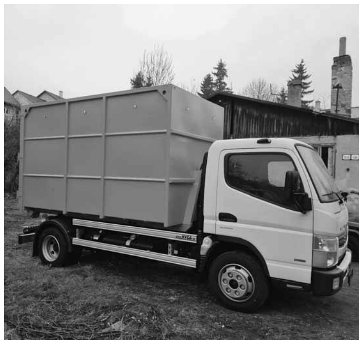
Hákový nosič kontajnerov a VKK v objeme 12 m 3 FOTO ARCHÍV TS, M.P., BŠ
