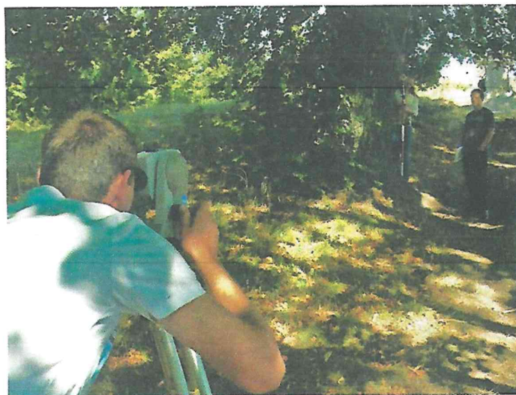
Zameriavanie metódou priestorovej tachymetrie
